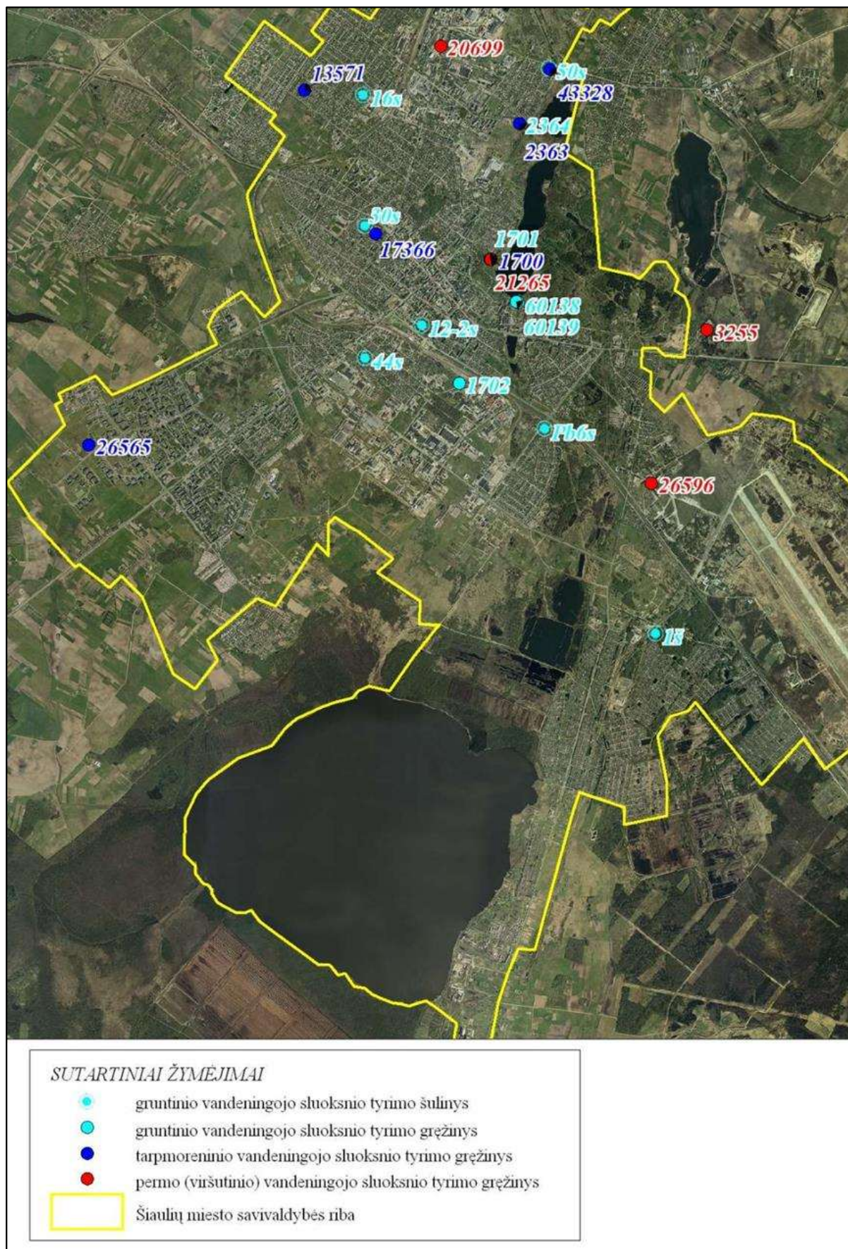
3 pav. Požeminio vandens monitoringo tinklas 2025 m.
